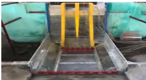
Hình 14: Mô hình thí nghiệm của Đặng Thị Hồng Huệ (2018) cho Công trình tràn xả lũ hồ chứa nước Chiềng Dong, Sơn La [2]
