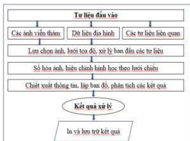
Hình 1.2: Sơ đồ tóm tắt quy trình xử lý thông tin ảnh và bản đồ
