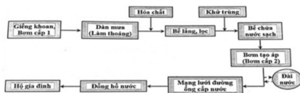
Hình 8: Quy trình công nghệ xử lý nước dưới đất [7]
