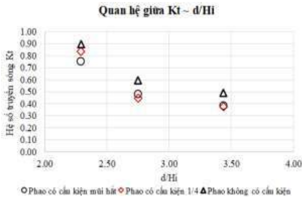
Hình 15: Quan hệ giữa hệ số truyền sóng và chiều cao sóng tới
