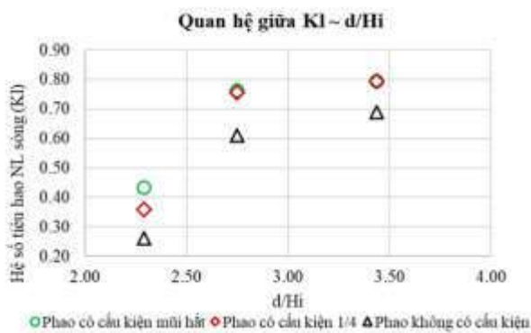
Hình 17: Quan hệ giữa hệ số tiêu hao năng lượng sóng và chiều cao sóng tới
