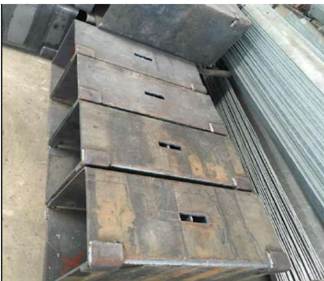
Hình 9: Hộp nổi cọc
