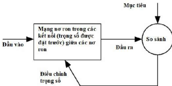
Hình 4. Sơ đồ khối mạng nơ-ron nhân tạo với giải thuật lan truyền ngược
