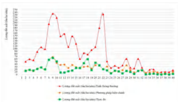
Hình 2: Đồ thị biểu diễn lượng đất mất đo tại các ô thực tế và kết quả tính toán lượng đất mất theo mô hình USLE thông thường và hiệu chỉnh hệ số C của nghiên cứu này.
