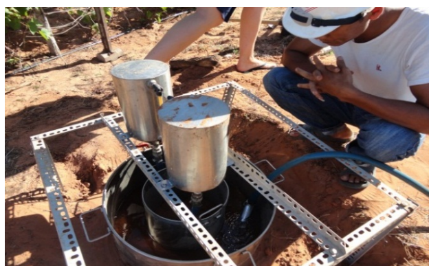
Hình 5: Quan trắc thí nghiệm thấm ổn định hiện trường và trong phòng của đất bão hòa
