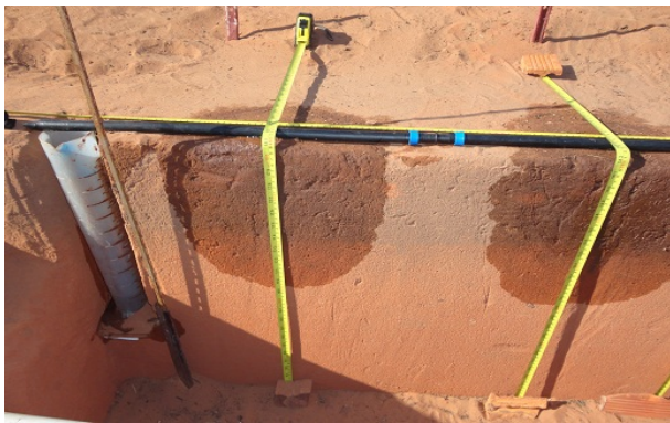
Hình 6: Quan trắc diễn biến thấm tại mô hình thực nghiệm, tỉnh Bình Thuận
