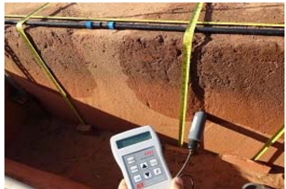
Hình 6: Quan trắc diễn biến thấm tại mô hình thực nghiệm, tỉnh Bình Thuận
