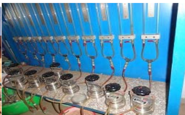
Hình 5: Quan trắc thí nghiệm thấm ổn định hiện trường và trong phòng của đất bão hòa
