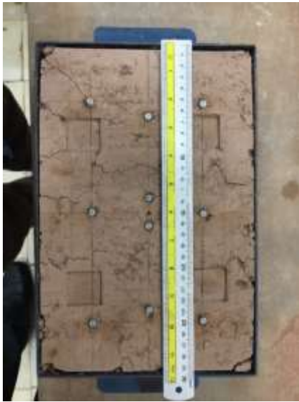
Hình 7: Đo biến dạng và vết nứt trên mẫu thí nghiệm ứng với độ ẩm mẫu 0%
