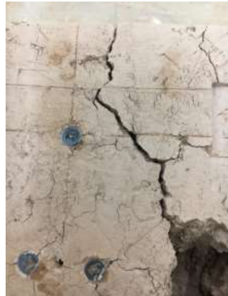
Hình 7: Đo biến dạng và vết nứt trên mẫu thí nghiệm ứng với độ ẩm mẫu 0%
