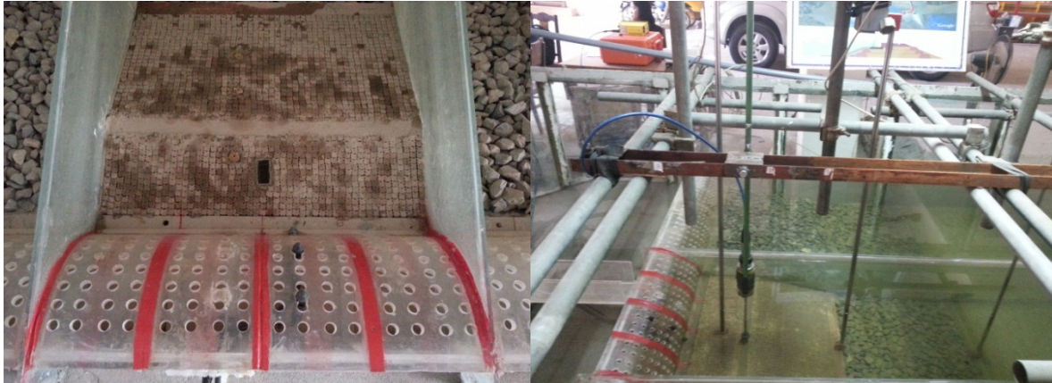
Hình 4. Thí nghiệm mô hình thủy lực mặt cắt đê có tiêu sóng hình trụ rỗng trên đỉnh
