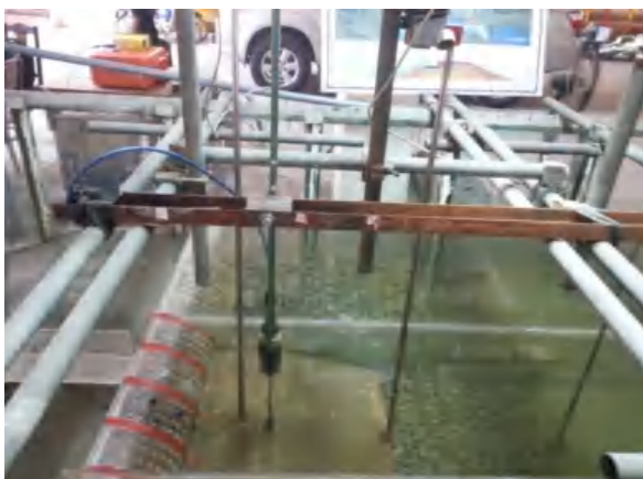
Hình 3: Thí nghiệm mô hình thủy lực mặt cắt đề có tiêu sóng hình trụ rỗng trên đỉnh
