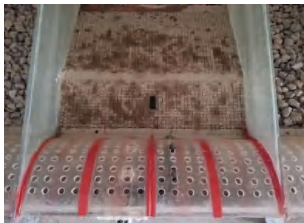
Hình 3: Thí nghiệm mô hình thủy lực mặt cắt đề có tiêu sóng hình trụ rỗng trên đỉnh
