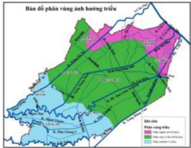
Hình 6: Bản đồ phân vùng ảnh hưởng triều từ kết quả tính toán MIKE11
