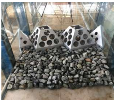
Hình 12. Mô hình cấu kiện thí nghiệm trong máng sóng [9, 11] và hệ số truyền sóng trong các điều kiện mực nước khác nhau
