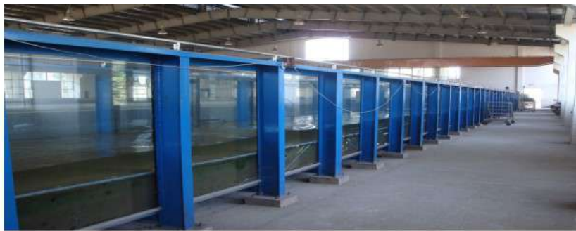
Hình 11. Máng sóng thí nghiệm của Viện Khoa học Thủy lợi miền Nam [9, 10]
