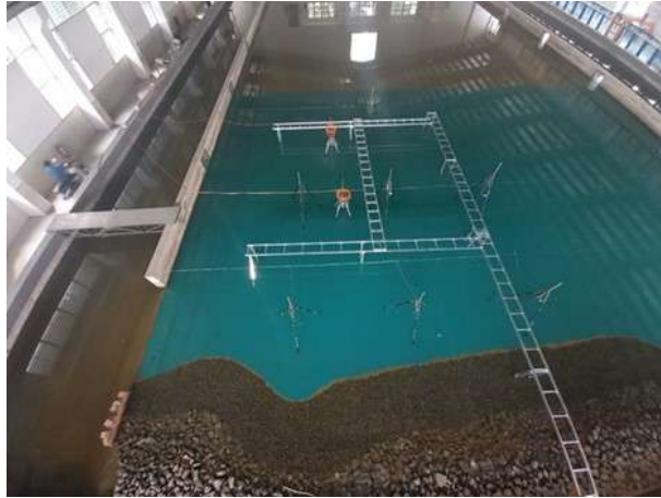
Hình 1. Bể sóng thí nghiệm và bố trí các kim đo sóng và dòng chảy tại Phòng thí nghiệm Viện Khoa học Thủy lợi miền Nam
