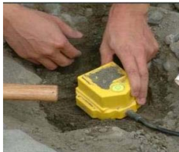
Cảm biến sóng âm lắp đặt bên bờ suối tại Đài Loan [10]
