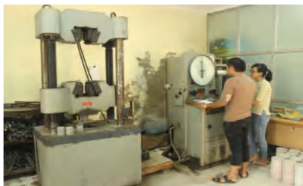
Hình 12: Thí nghiệm nén mẫu
