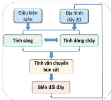
Hình 2: Sơ đồ kết nối module sóng, dòng chảy và VCBC trong mô hình Delft3D
