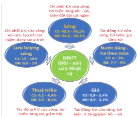
Hình 10: Sơ đồ đánh giá tác động của các yếu tố động lực đến biến động hình thái cửa Nhật Lệ tính theo tỷ lệ bồi - xói lòng dẫn
