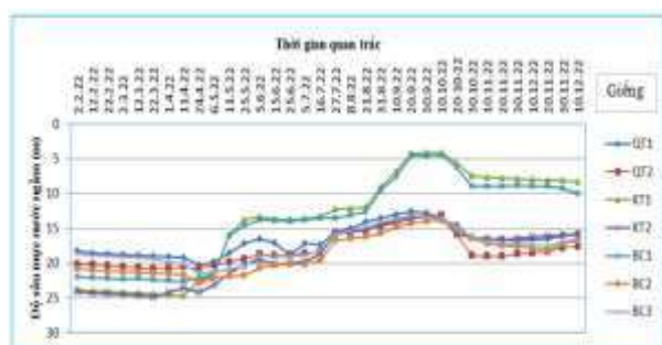
Hình 2: Kết quả quan trắc mực nước dưới đất tại các lỗ khoan trên đảo
