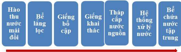
Hình 2. Sơ đồ công nghệ thu gom, bổ cập và khai thác nước tại đảo Hòn Ngang
