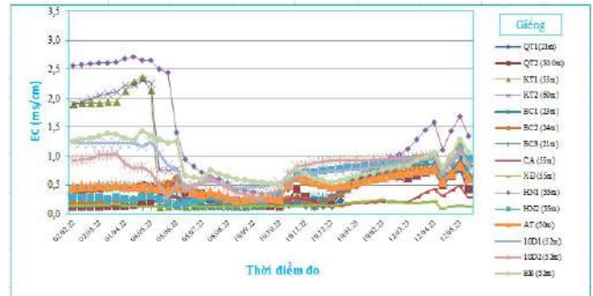
Hình 8. Kết quả quan trắc EC tại các lỗ khoan trên đảo (tháng 2/2022 - 5/2023)
