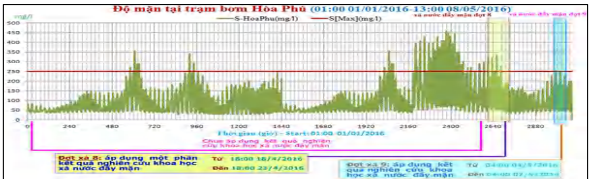
Hình 3.29: Độ mặn tại trạm bơm Hòa Phú trên Sông Sài Gòn sau khi xả nước đẩy mặn từ hồ Dầu Tiếng, từ 01:00 01/01/2016 đến 13:00 08/5/2016
