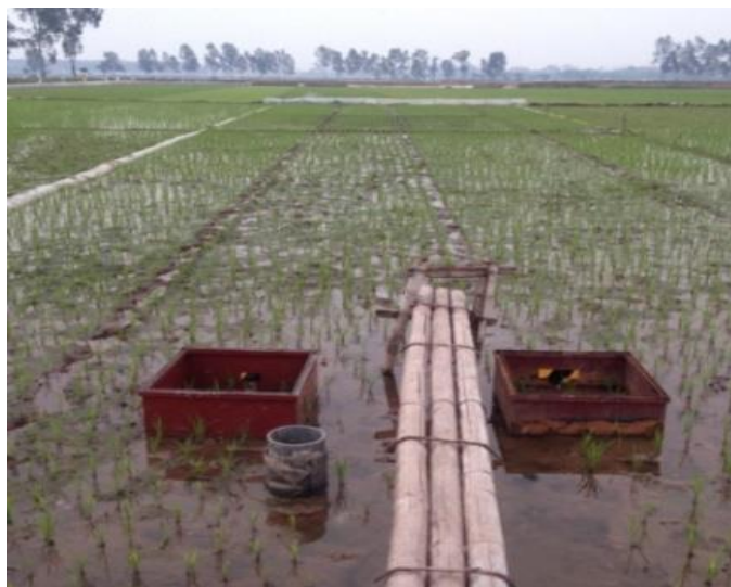
Hình 2.8. Chân đế hộp lấy mẫu khí N_2O
