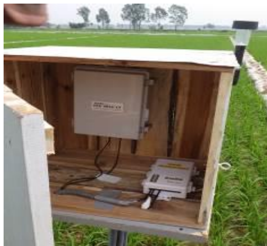
Hình 2.5. Thiết bị đo tự động mực nước, quan trắc mực nước trên ruộng, thiết bị đo cảm biến độ ẩm, cảm biến điện phân chất hữu cơ trong đất, tủ ghi số liệu và thiết bị đo Eh cầm tay
