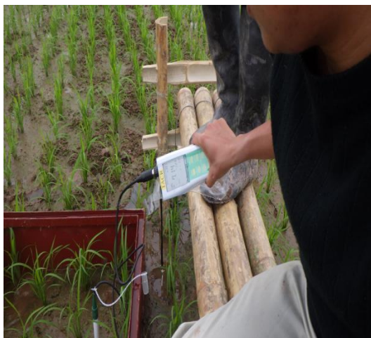
Hình 2.5. Thiết bị đo tự động mực nước, quan trắc mực nước trên ruộng, thiết bị đo cảm biến độ ẩm, cảm biến điện phân chất hữu cơ trong đất, tủ ghi số liệu và thiết bị đo Eh cầm tay
