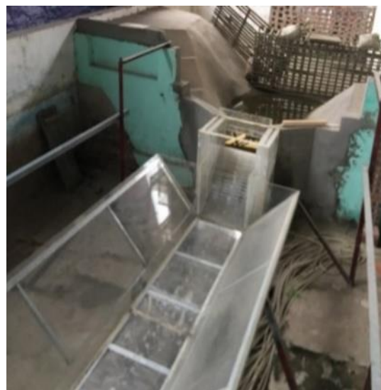
Hình 2.15 Lắp đặt đập đầu mối và hoàn thiện trên mô hình với b = 55\text{cm}
