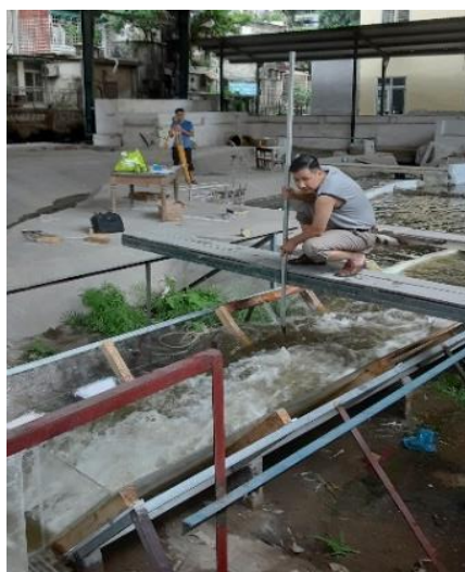
Hình 2.21 Đo số liệu mực nước từ MIA trên mô hình có b = 33,5\text{cm}
