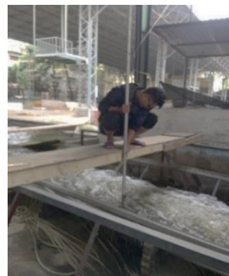
Hình 2.20 Đo mực nước bằng MIA với kênh có b = 55\text{cm}
