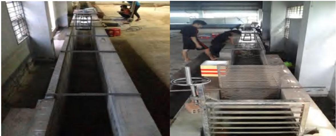
Hình 2.20. Cài đặt lưu tốc nước và quan trắc khả năng di chuyển của TCX trong kênh nước hở (Nguồn: Thiết bị Phòng thí nghiệm Viện KHTLMN)
