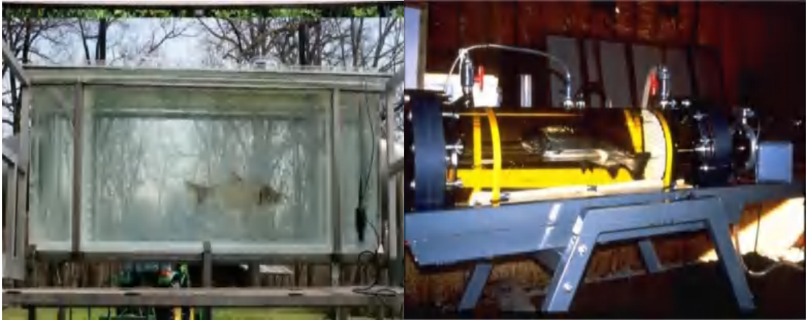
Hình 1.16. Thiết bị thủy lực thử nghiệm khả năng di chuyển (Nguồn: Clough và Turnpenny, 2001 [38]; Katopodis và Gervais, 2016 [56])
