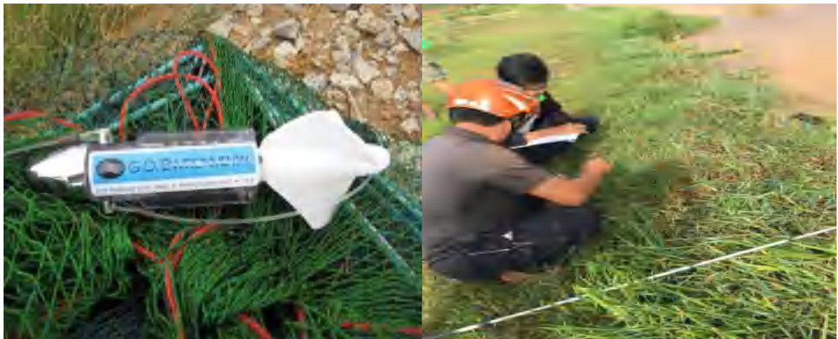
Hình 2.19. Lưu tốc kế đo đặc tại ĐDCQĐ Phước Hòa (Nguồn: Thiết bị được sử dụng tại hiện trường ĐDCQĐ Phước Hòa)
