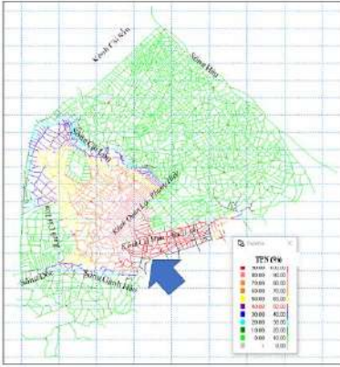
Hình 3.7: Phân bố thành phần nguồn nước biển Bạc Liêu – Gành Hào khi có công trình ngăn mặn (1/2016)
