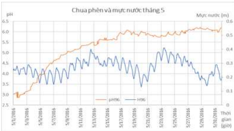
Hình 5: Biểu đồ diễn biến pH và mực nước theo thời gian, tại mặt cắt 96 (nhánh 30) thuộc kênh Hà Giang theo trong tháng 5
