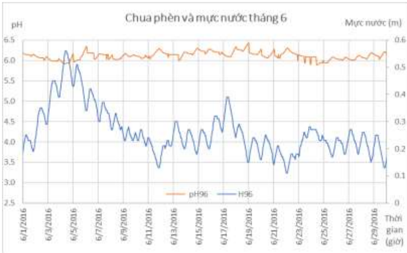
Hình 6: Biểu đồ diễn biến pH và mực nước theo thời gian, tại mặt cắt 96 (nhánh 30) trong tháng 6
