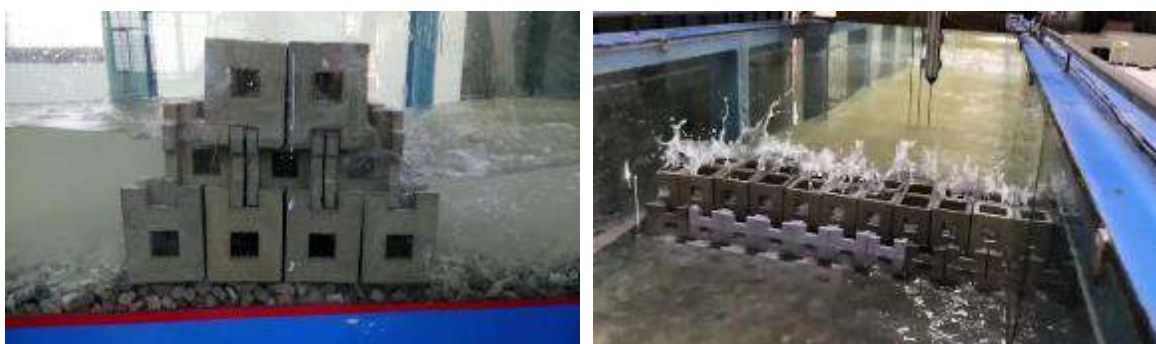
Hình 2-4. Mô hình ĐGS trong máng sóng
