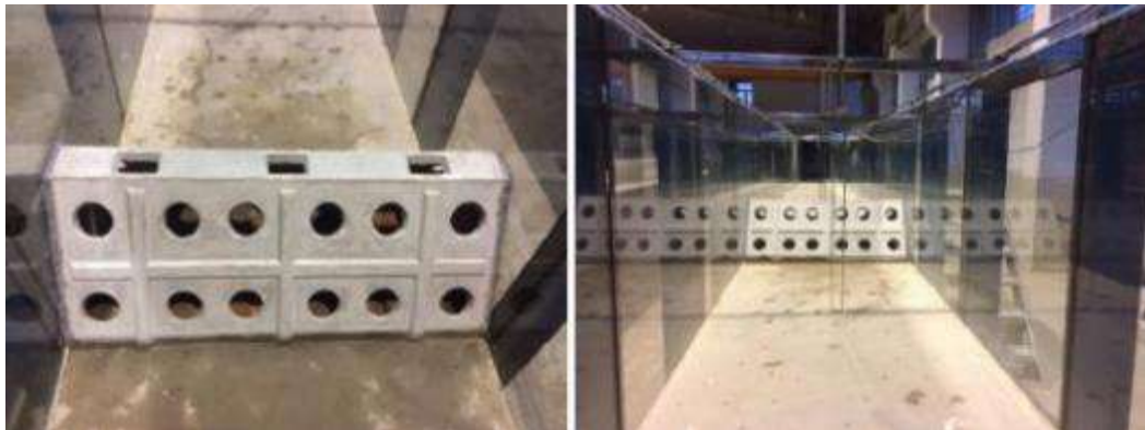
Hình 1-16. Mô hình thí nghiệm truyền sóng qua ĐGS kết cấu rỗng
