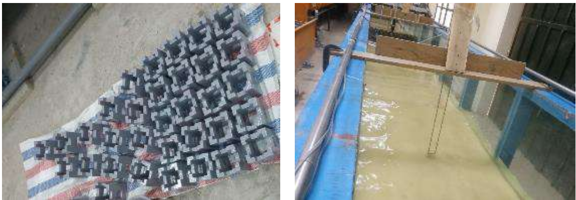
Hình 2-5. Chế tạo cấu kiện và lắp đặt các đầu đo trong máng sóng
