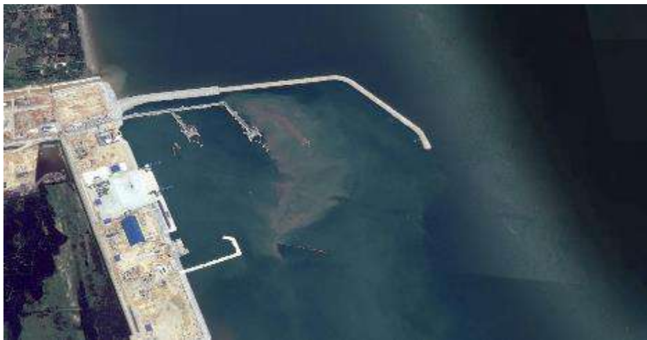
Hình 1-8. Đê chắn sóng tại Nghi Sơn, Thanh Hóa sử dụng khối Rakuna-iv
