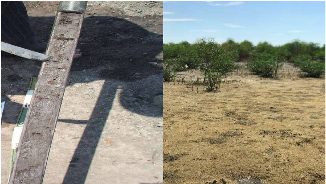
Hình 2- 6: Xác định dạng lập địa và thu mẫu đất bằng khoan chuyên dụng
