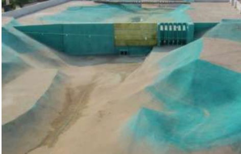
Hình 2.3. Mô hình vật lý vỡ đập bê tông
