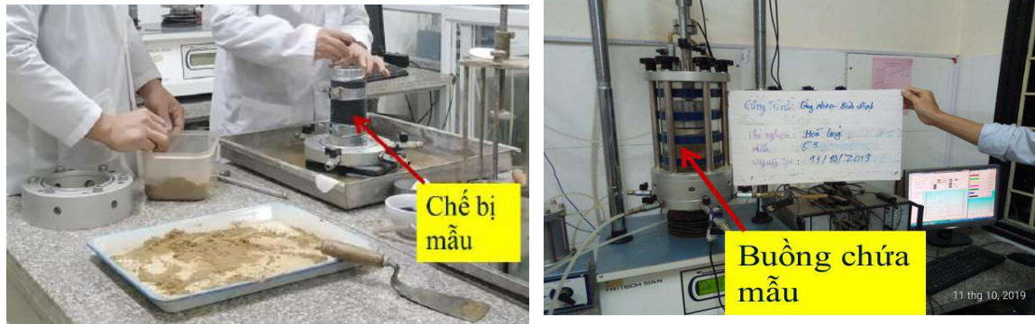
Hình 3.15. Chén bị mẫu và đưa mẫu vào buồng chứa mẫu
