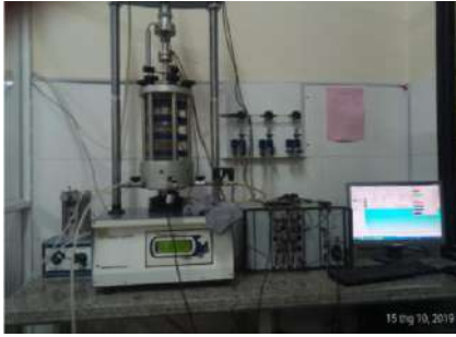
Hình 3.8. Hệ thống thiết bị ba trục Trittech 100 và bộ ghi xuất dữ liệu tự động
