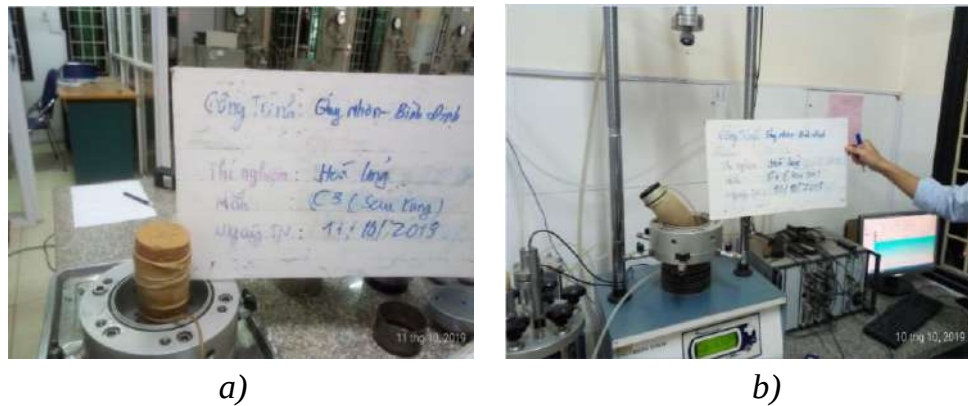
Hình 3.16. Mẫu cát sau khi thí nghiệm ba trục gia tải lặp
