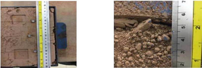
Hình 2.10 - Vết nứt phát triển và co ngót của mẫu
