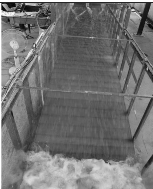
Ảnh 3: Dòng chảy trên dốc nước - PAD1, Z_{TK}=54.64\text{m}
