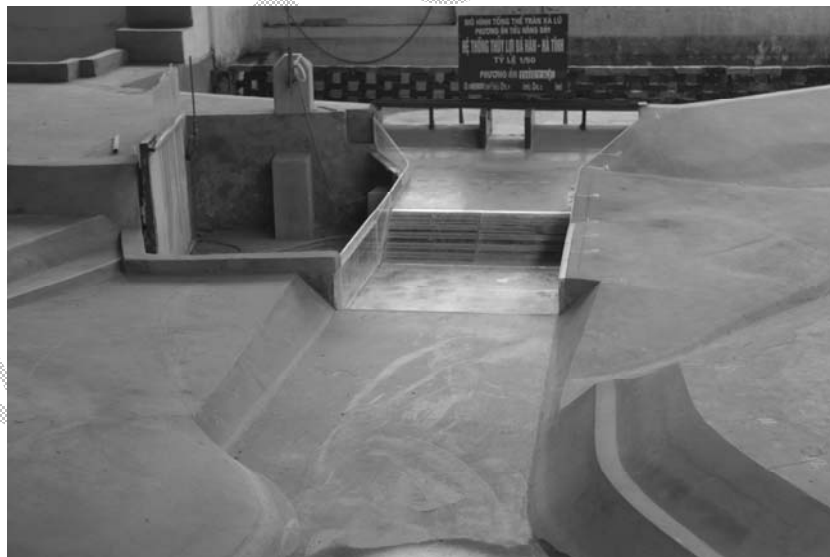
Hình 2: Mô hình tràn xả lũ Đá Hàn
