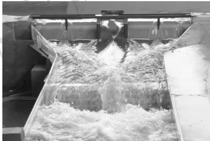
Hình 3: Dòng chảy xiên và dải sóng trên dốc nước - PAIK.
