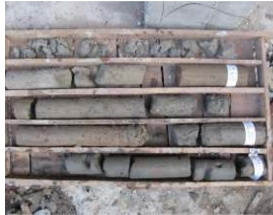
Hình 4.9 Lõi khoan cọc A2
