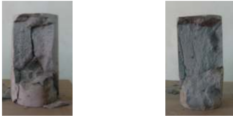
Hình 4.10 Phá hoại mẫu M1, M2 trong thí nghiệm nén nở hông
