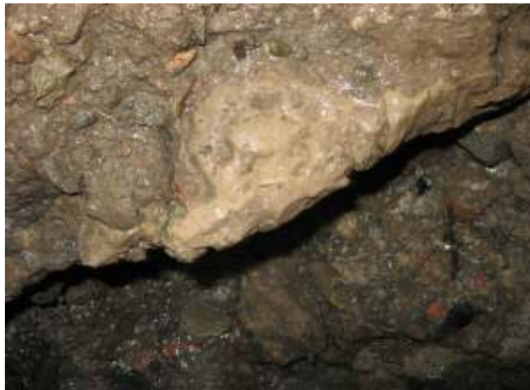
Hình 4.13 Vữa xi măng nằm xen kẽ trong lớp đất.
