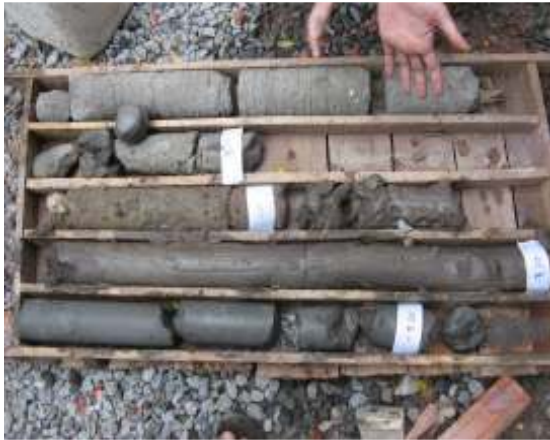
Hình 4.8 Lõi khoan cọc A1
