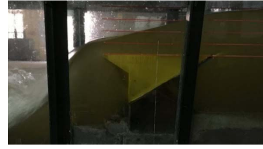
d.Cột nước tràn lớn ( H_0/W_0=1.9 )
