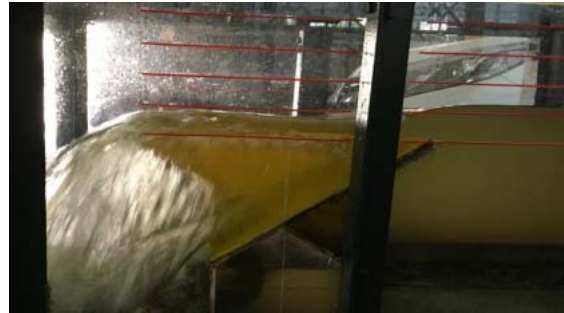
Hình 4 : Kết quả kiểm nghiệm, hiệu chỉnh mô hình trường hợp H/P=0,4
