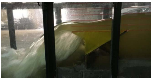
c.Cột nước tràn khá lớn ( H_0/W_0=1.5 )
