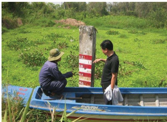
Hình 1.16. Khảo sát mực nước trên kênh và ống đo nước ngầm trong VQG
