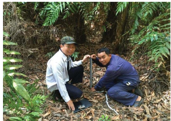
Hình 1.16. Khảo sát mực nước trên kênh và ống đo nước ngầm trong VQG
