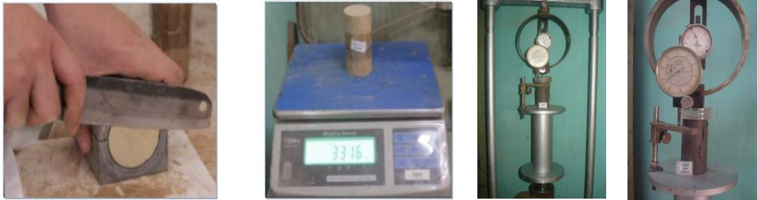
Hình 3.4: Quá trình thí nghiệm nén mẫu
