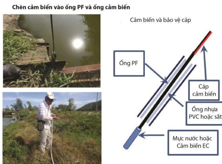
Hình 1.9. Lắp đặt cảm biến mực nước vào ống dẫn
