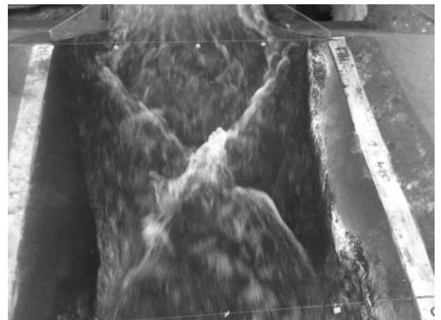
Hình 6. Nước nhảy thứ cấp trên kênh hạ lưu
