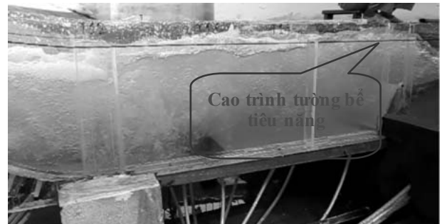
Hình 5. Nước nhảy vượt tường bể tiêu năng
