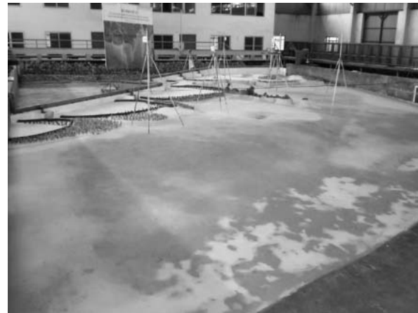
Hình 3. Mô hình chế tạo thí nghiệm với hướng sóng mùa gió Tây Nam.
