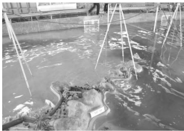
Hình 20. Lan truyền độ đục qua eo biển giữa mũi Đồ Sơn và mũi Hòn Dấu
