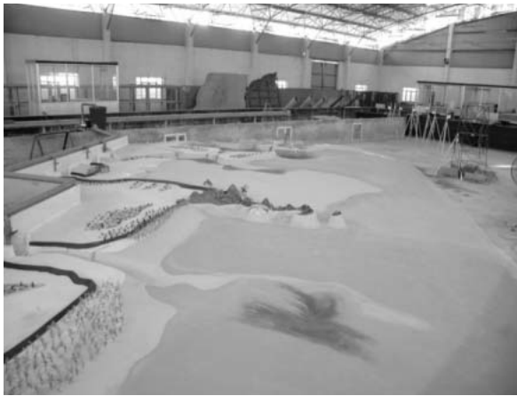
Hình 2. Mô hình chế tạo thí nghiệm với hướng sóng mùa gió Đông Bắc.
